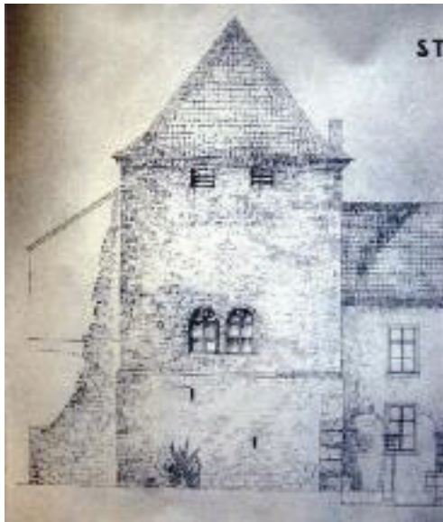
Abb. 13: Ernst Stahl, Bestandsaufnahme nach der Renovierung 1926-1929, Lichtpause, 54 x 94 cm, Ansicht von Süden, signiert „Der Architekt B.D.A. Ernst Stahl, 1931“. Europäisches Burgeninstitut, DBV-Archiv, Plansammlung, Braubach. Das Zwillingsfenster an der Südseite des Turms wurde in der vorgefundenen Form belassen.
