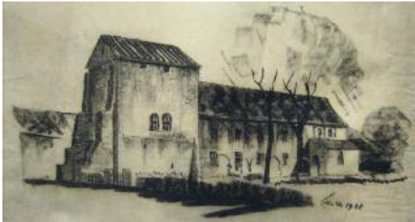
Abb. 8: Ernst Stahl, Rekonstruktionsentwurf mit einem Satteldach auf dem Westturm, Kohlezeichnung auf Pergamentpapier, 30 x 48 cm, 1926, Europäisches Burgeninstitut, DBV-Archiv, Plansammlung, Braubach. Der Westturm sollte so weit wieder aufgemauert werden, dass an seiner Südseite zwei Scharten entstanden wären. Darüber sollte ein leicht überstehendes einfaches Satteldach ansetzen.
