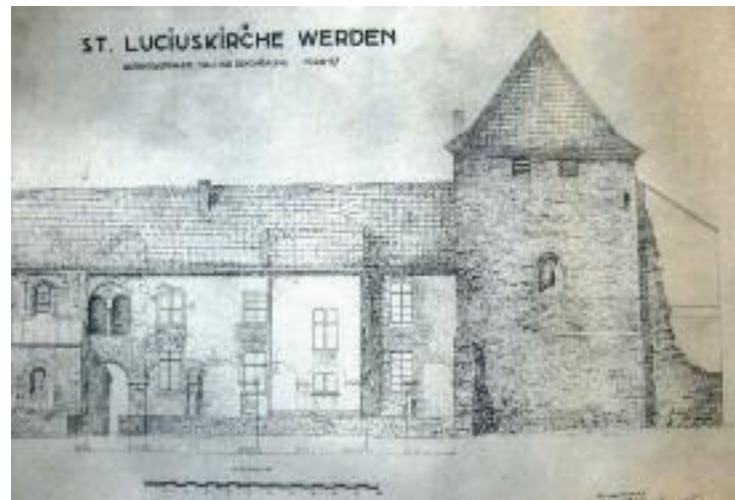
Abb. 16: Ernst Stahl, Bestandsaufnahme nach der Renovierung 1926-1929, Lichtpause, 54 x 94 cm, Ansicht von Norden, signiert „Der Architekt B.D.A. Ernst Stahl, 1931“. Europäisches Burgeninstitut, DBV-Archiv, Plansammlung, Braubach. Die ruinöse Mauerkrone wurde so weit aufgemauert, dass zwei annähernd quadratische Schalllöcher entstanden, die an Scharten erinnern.
