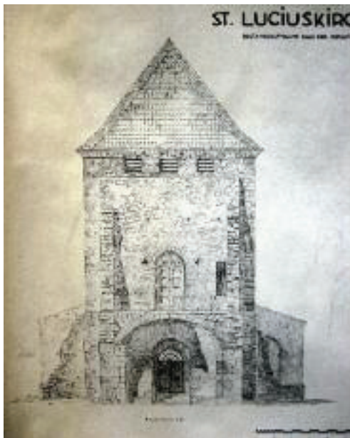
Abb. 14: Ernst Stahl, Bestandsaufnahme nach der Renovierung 1926-1929, Lichtpause, 54 x 94 cm, Ansicht von Westen, signiert „Der Architekt B.D.A. Ernst Stahl, 1931“. Europäisches Burgeninstitut, DBV-Archiv, Plansammlung, Braubach. Die 1926-27 vorgenommene Rekonstruktion hinterließ den Westturm mit annähernd quadratischen Schallöffnungen in Form von Scharten unmittelbar unter dem Turmhelm, drei auf der westlichen, je zwei auf den anderen Turmseiten. Der Turm hatte danach einen geknickten Pyramidenhelm. Der westliche Vorbau wurde nicht rekonstruiert, ebenso nicht die Seitenschiffe und die Chorflankentürme.
